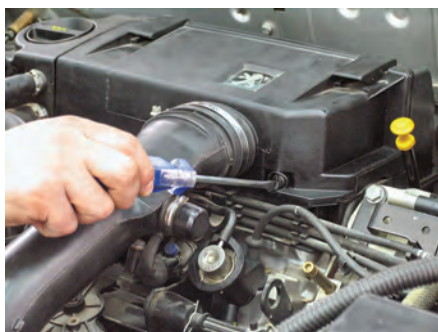
شکل (۲-۶۵) نصب در پوش محافظه فیلتر هوا
