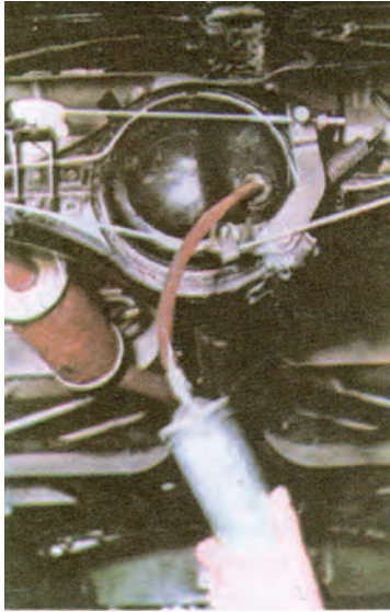
شکل (۲-۷۶) شارژ روغن دیفرانسیل
