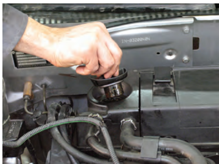
شکل (۴۵- ۲) بازکردن در قالباق موتور
