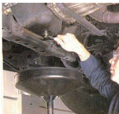
شکل (۲-۵۷) بستن پیچ تخلیه با گشتاور مناسب
