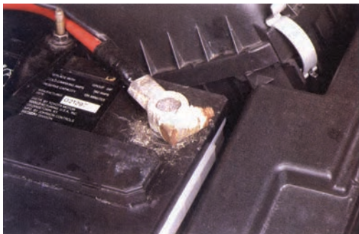
شکل (۲-۸۱) سولفات شدن بست باتری
