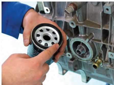
شکل (۲-۵۳) کنترل دندانه و واشر لاستیکی فیلتر
