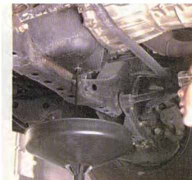
شکل (۲-۵۲) تخلیه روغن در ظرف مناسب
