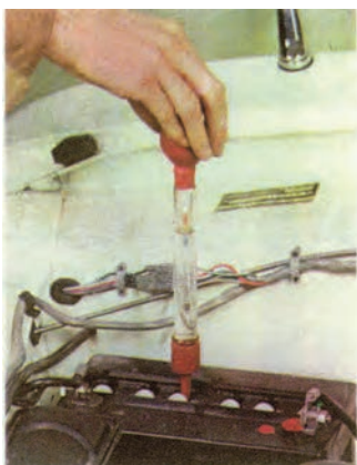
شکل (۲-۸۸) اندازه گیری غلظت مایع باتری
