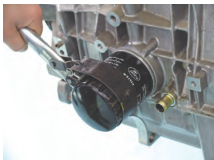
شکل (۴۸- ۲) بازکردن فیلتر با ابزار مخصوص
