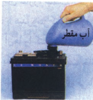
شکل (۲-۸۹) اضافه کردن مایع باتری
