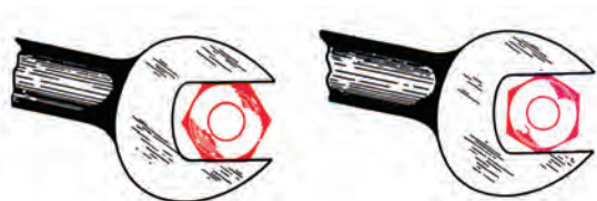
شکل (۱-۳) استفاده‌ی اصولی از ابزار
