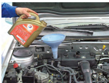
شکل (۲-۵۸) شارژ با روغن توصیه شده
