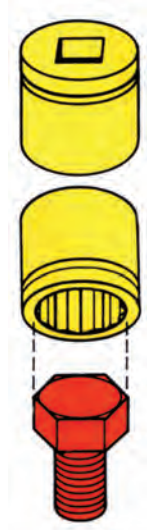
شکل (۱-۱۷) نحوه درگیری آچار بوکس
