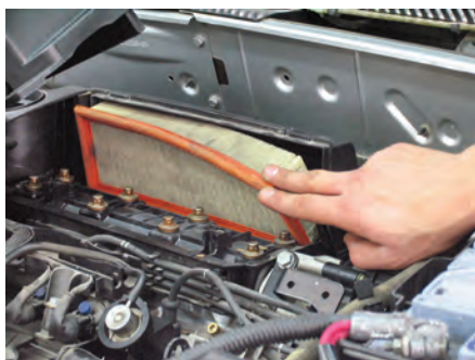
شکل (۲-۶۴) پیاده کردن فیلتر هوا
