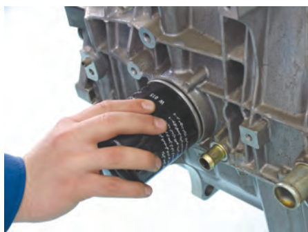
شکل (۲-۵۴) نصب و محکم کردن فیلتر
