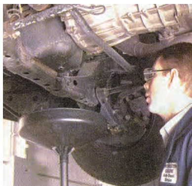
شکل (۲-۵۵) کنترل تخلیه شدن کامل روغن
