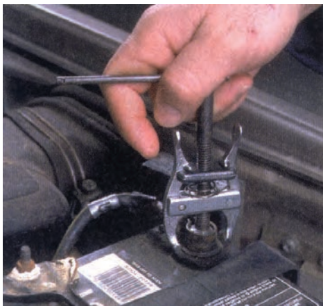
شکل (۲-۸۲) باز کردن بست باتری
