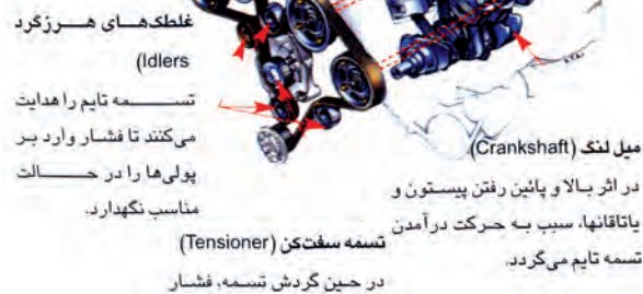
شکل (۱۳-۲ الف) تسمه تایمینگ موتور
